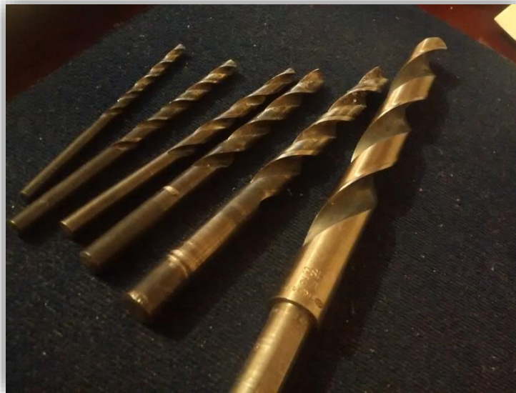
Figura 4.E. Algunas de las brocas empleadas en el barrenado del P.T.R.
