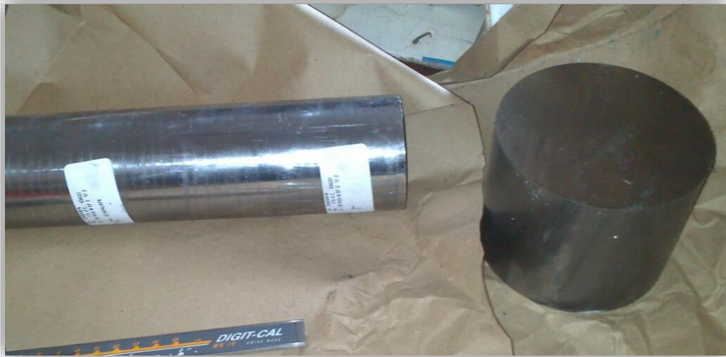
Figura 4.J. Material usado en la elaboración del eje y de la jaula del rodamiento de empuje
