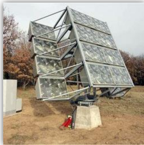
Figura G. Torre fotovoltaica de alta concentración
