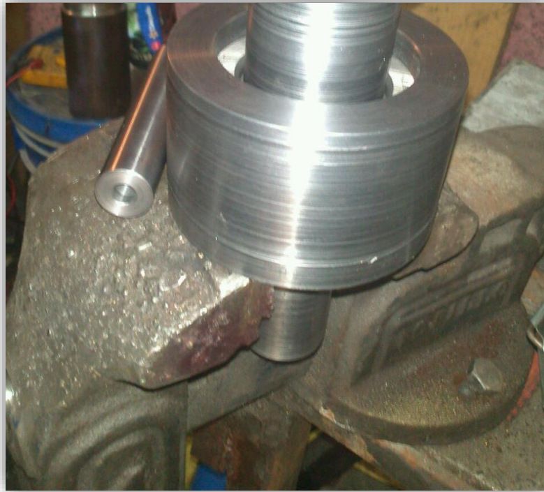
Figura 4.N. Ensamble del eje, el contenedor y el rodamiento de empuje. Atrás uno de los ejes superiores
