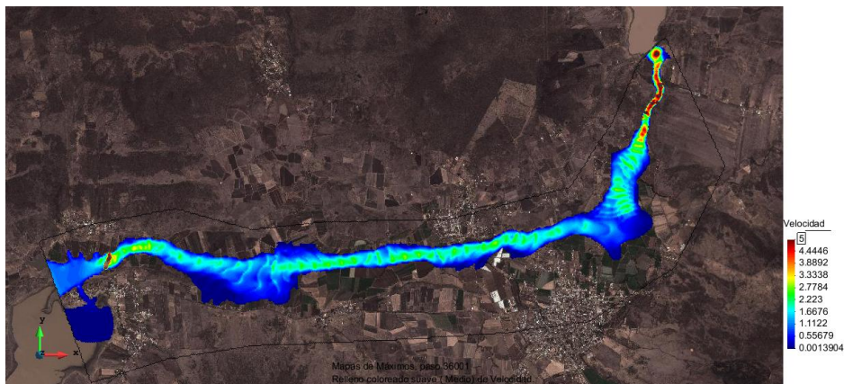
Figura 48. Velocidades máximas presentadas durante la simulación del hidrograma de ruptura de la cortina.
