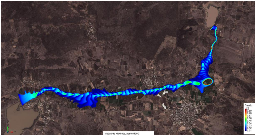
Figura 44. Mapas de máximas profundidades alcanzadas aguas abajo de la presa, por las descargas de ésta, para un periodo de retorno de 100 años.
