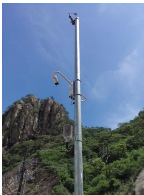
Figuras 44 y 45. Estación meteorológica Se monitorea una vez a la semana para verificar su correcto funcionamiento, y se limpia de cualquier bicho o suciedad que pueda caer en el pluviómetro. Túnel Carrizo II. Fotos de mi autoría.
