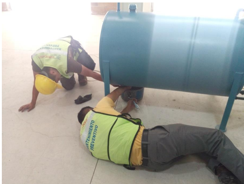
Figura 15. Periódicamente se drenaban los tanques de diesel de los equipos Astronic con la finalidad de eliminar impurezas y así evitar que se contaminaran los sistemas de inyección de los equipos.
