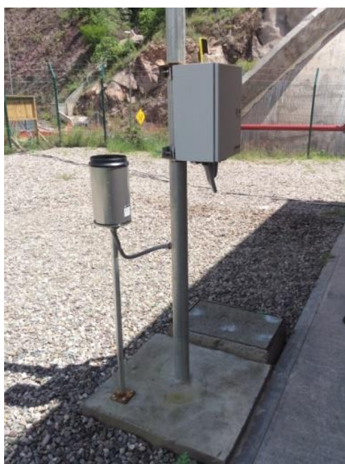
Figuras 44 y 45. Estación meteorológica Se monitorea una vez a la semana para verificar su correcto funcionamiento, y se limpia de cualquier bicho o suciedad que pueda caer en el pluviómetro. Túnel Carrizo II. Fotos de mi autoría.
