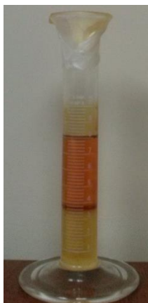
Fotografía 10 Volumen de fluidos recuperados
