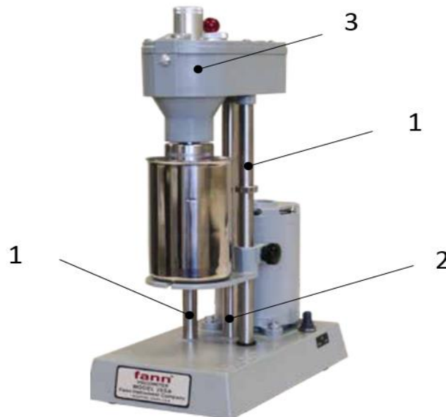
Figura 24. Viscosímetro Fann 35. Este dispositivo cuenta con tres barras de soporte. Las barras (1) soportan todo el mecanismo de transmisión (3) de la parte superior, así como la base donde asienta el vaso. La barra (2) se usa primordialmente para transmitir potencia del motor a la transmisión (3), aunque su función también es de soporte [2].
