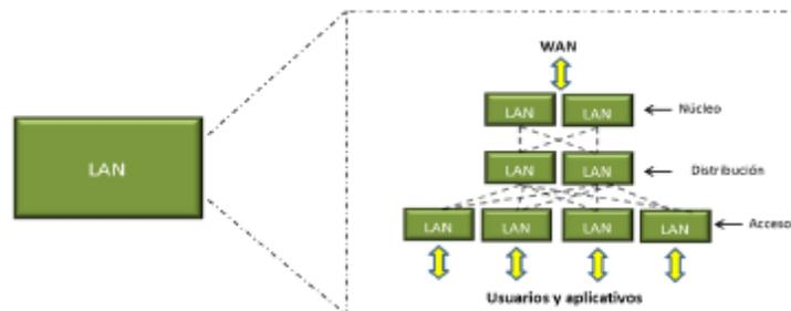
Figura 3.11 Arquitectura Jerárquica del Módulo LAN
