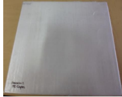
Figura 4.4 b) Probeta después del ciclo de termoformado
