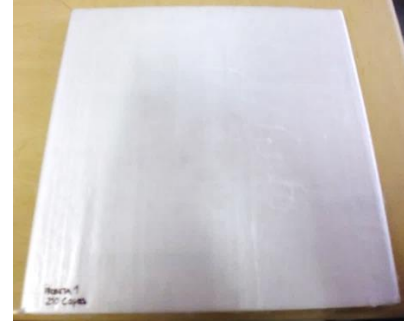
Figura 4.6 b) Probeta después del ciclo de termoformado
