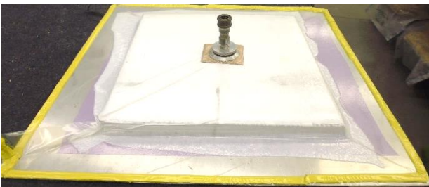
Figura 4.7 a) Probeta antes del ciclo de termoformado
