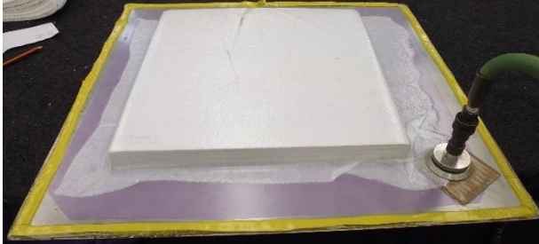
Figura 4.6 a) Probeta antes del ciclo de termoformado
