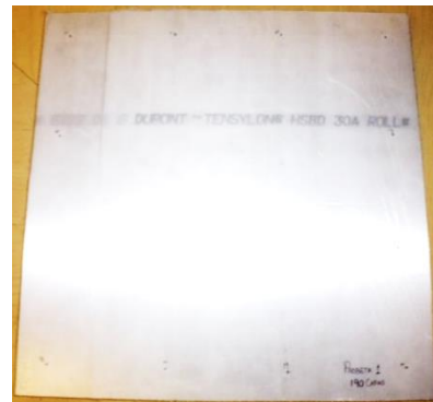
Figura 4.5 b) Probeta después del ciclo de termoformado
