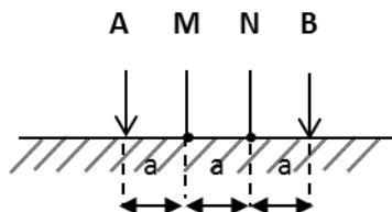
Figura 3. Dispositivo Wenner. Electrodo de corriente A y B, electrodos de potencial M y N (Modificada de Loke, 2010).
