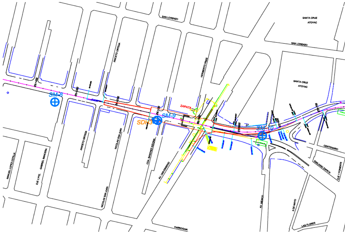
Ilustración 18 Localización de los sondeos en planta para la estación Zapata, comprende los sondeos SM-9, SM-10 y SDH-3
