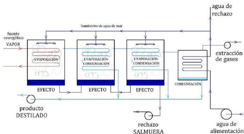
Figura 1.14 Esquema MED Convencional (Salmerón Vergara, 2012)
