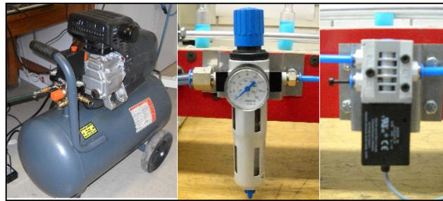
*Figura D5. Componentes neumáticos.
