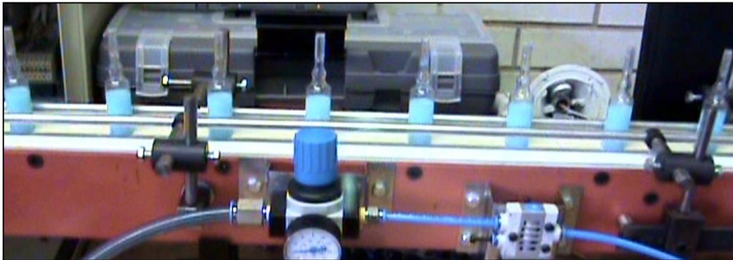
*Figura 5.6. Distribución de las ampollas en el transportador.*
