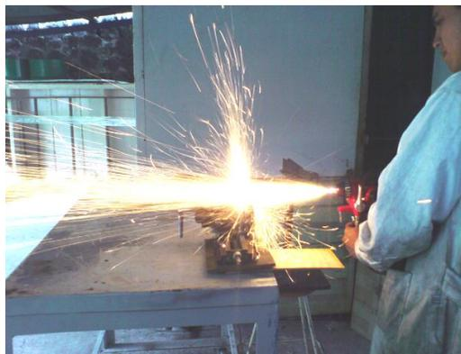
Fig. 6.8 Proceso de proyección térmica con alimentación de alambre.<sup>85</sup>
