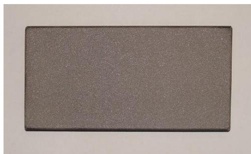
Fig. 6.4 Sustrato granallado.<sup>82</sup>
