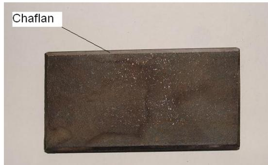
Fig. 6.1 Sustrato de acero cortado, con chaflán.<sup>79</sup>
