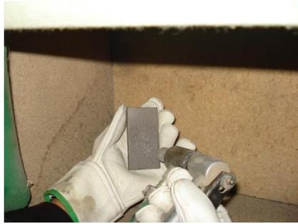
Fig. 6.2 Proceso de granallado.<sup>80</sup>
