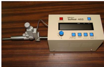
Fig. 6.3 Rugosímetro digital.<sup>81</sup>
