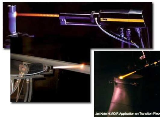
Figura 2.8 Pistolas de proyección térmica por combustión de alta velocidad.<sup>32</sup>
