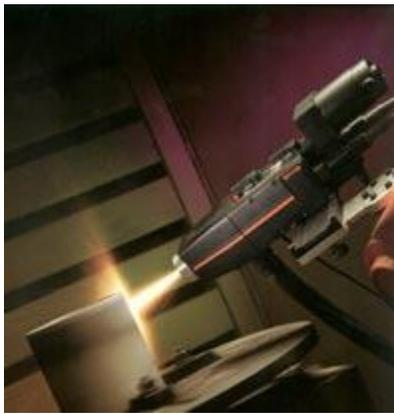
Figura 1.15 Elemento estructural de acero siendo recubierto mediante un equipo de arco eléctrico.<sup>17</sup>
