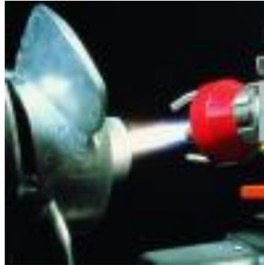
Figura 1.13 Propela de barco recubierta con equipo HVOF.<sup>15</sup>
