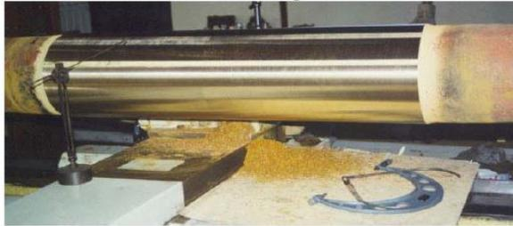
Figura 1.20 Recubrimiento maquinado. Eje listo para volver a prestar servicio.<sup>19</sup>
