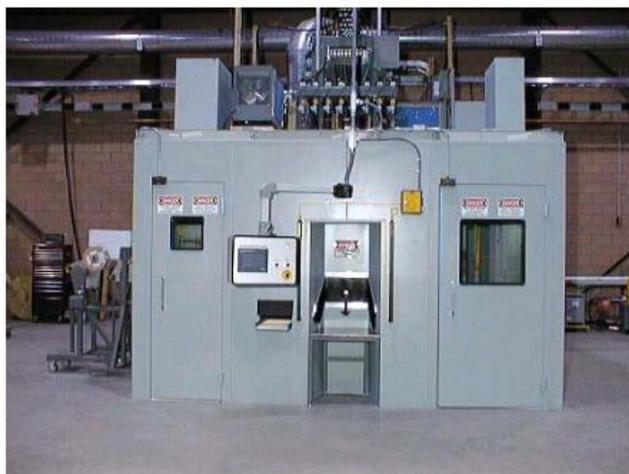
Figura 4.9 Cuarto de aislamiento acústico.<sup>71</sup>
