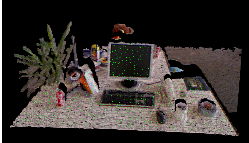
Figura 7.3: Ejemplo de puntos característicos detectados en una nube de puntos usando ISS.
