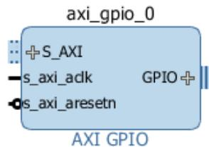
Figura 4.6: Módulo AXI GPIO.
