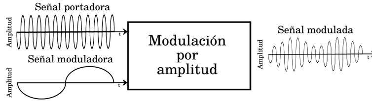
Figura 2.5: Modulación por amplitud.
