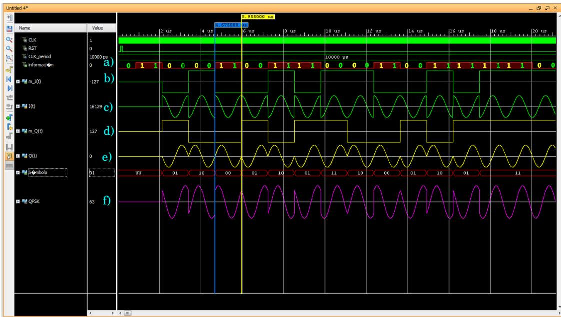
Figura 5.3: Resultado de la simulación de la arquitectura del modulador QPSK implementado en VHDL.
