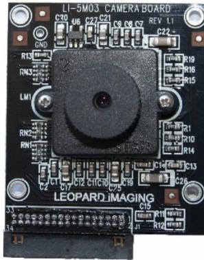
Figura 3.13: Cámara de fotos LI-5M03 de Leopard Imaging empleada como cámara de percepción remota.
