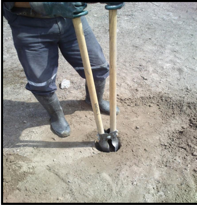
Figura 5.12. Toma de la muestra JLP11 (muestra testigo) en un sitio apartado de las presas de jales mediante un cavahoyos.
