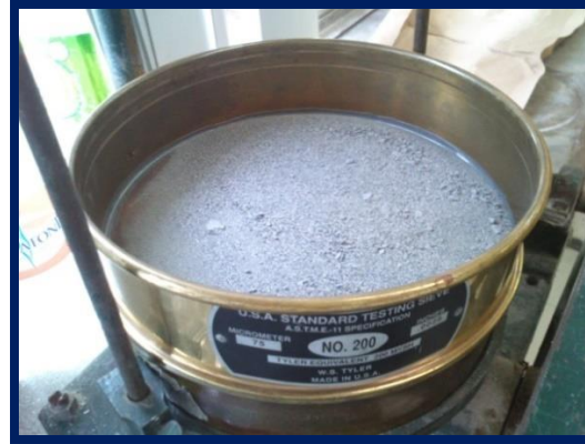
Figura 5.21. Tamizado de las muestras a malla 200 a un tamaño de partícula de 75 \mu\text{m} .
