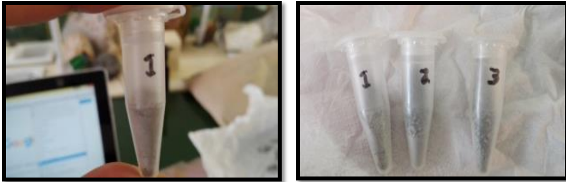
Figura 5.48. Colocación de muestra en los recipientes de polietileno de alta densidad
