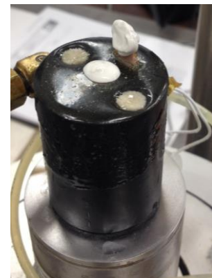
Figura 25 Mezcla de caolín para hacer contacto cristales-suelo
