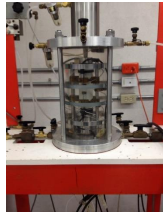
Figura 8 Cámara triaxial neumática con probeta
