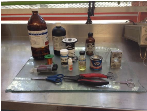
Figura 13 Equipo y material para instrumentación de cristales piezoeléctricos
