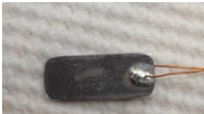
Figura 18 Elemento de flexión con mica auto-adherible
