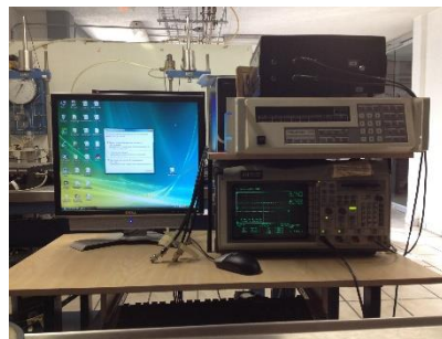
Figura 19 Equipo para medir tiempo de arribo de ondas
