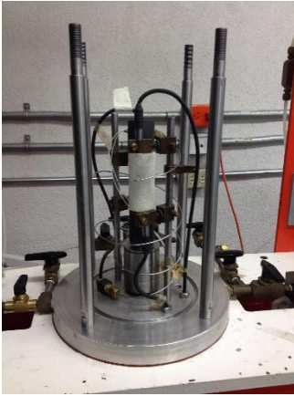
Figura 9 Vista de transductores de cámara triaxial neumática
