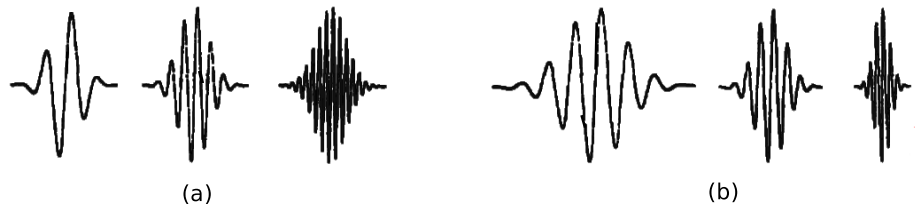
Figura 3.5: Funciones base de las ventanas (a) STFT (b) Wavelet . [43]
