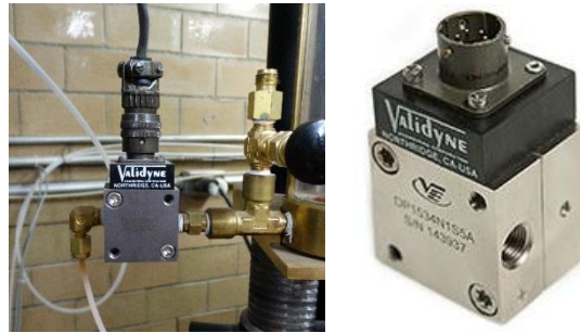
Figura 23: Transductor de presión diferencial Validyne, modelo DP15-28.
