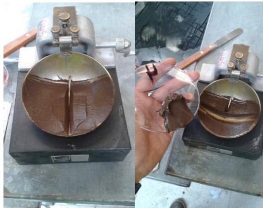
Figura 15: Ranurado de la muestra y toma de muestra de suelo.
