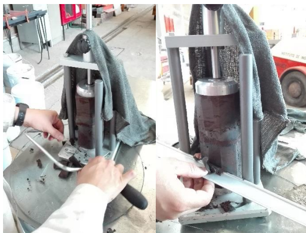
Figura 9: Labrado de probeta de suelo.
