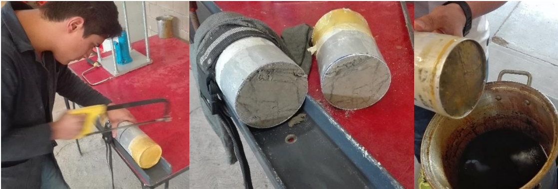
Figura 7: Corte y encerado de tubo aluminio tipo Shelby.
