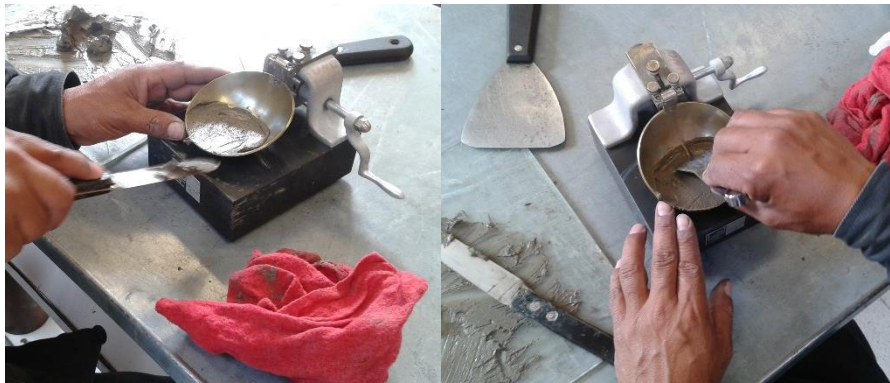
Figura 14: Colocación y ranurado del suelo en la copa Casagrande.
