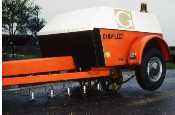
Figura 3: El sistema Dynaflect en posición operativa
