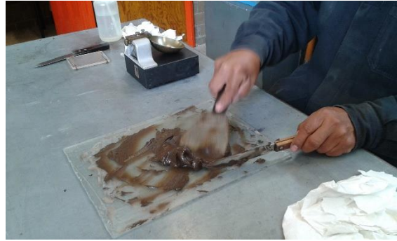
Figura 13: Remoldeo de material para el ensayo del límite líquido.
