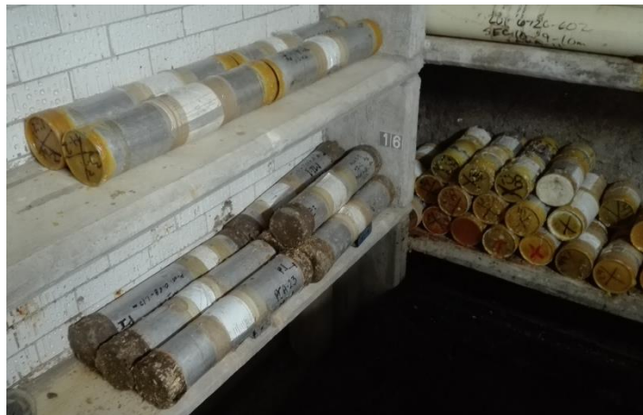
Figura 6: Almacenamiento de tubos tipo Shelby en cuarto húmedo.
