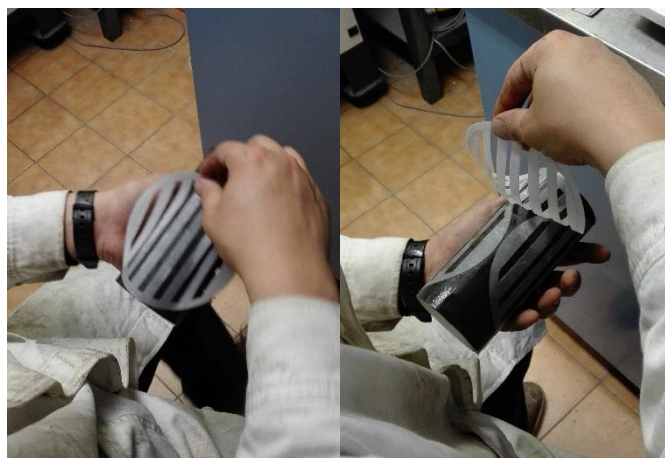
Figura 11: Colocación de papel filtro previamente saturado a muestra de suelo.
