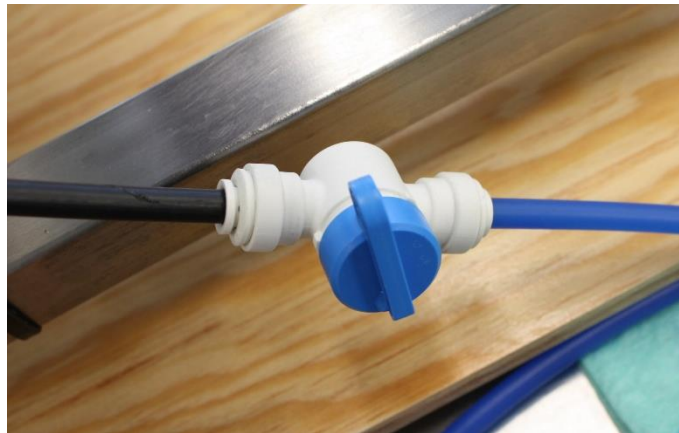
Válvula de control de rechazo
