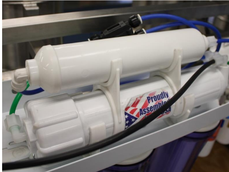
Módulo ósmosis inversa.
