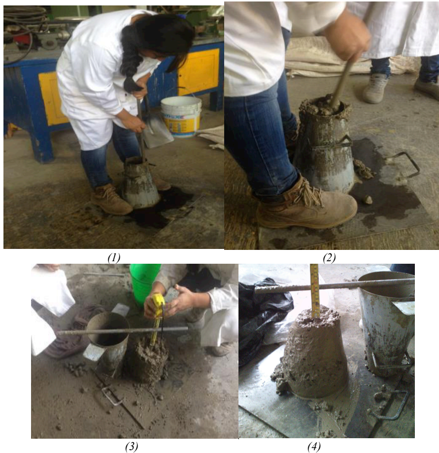
Figura 3.9 Prueba de revenimiento
