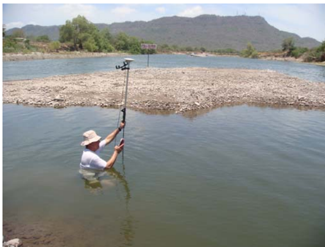
Figura IV-37. Los levantamientos de zonas donde se extraen materiales pétreos en lechos de los ríos han sido de enorme ayuda en la Dirección Local Nayarit para mostrar evidencia a las empresas que se dedican a ello para el pago del usufructo correspondiente con datos medidos sobre el terreno. Tepic, Nayarit.
