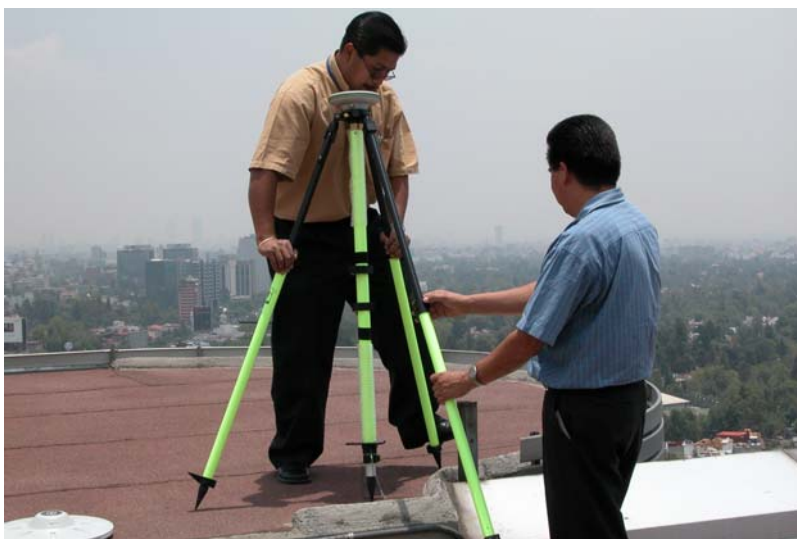
Figura IV-41. Montaje de antena externa de la Estación de Referencia. Estación de Referencia AMOXCALLI, México, Distrito Federal.
