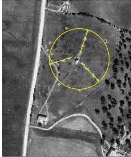
Figura I-4. Cadena 1 Decca en España. Nótese el arreglo de las antenas localizadas sobre el terreno. Nótese el arreglo en forma de "Y" para la transmisión de las señales.
