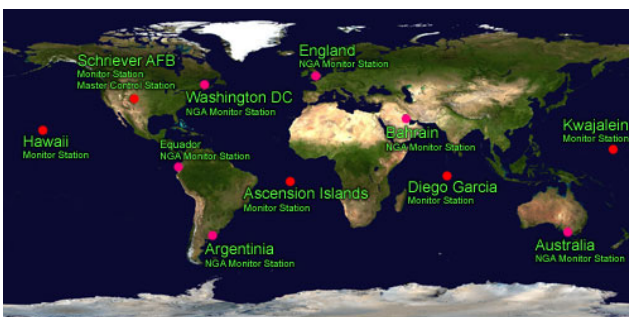
Figura I-13. Estaciones de Control GPS ubicadas alrededor del Ecuador y foto panorámica de la Estación de Monitoreo localizada en Hawaii, USA. (Fuente: NASA y Folleto de la Base de la Fuerza Aérea Schriever, vol. 6. N° 12)
