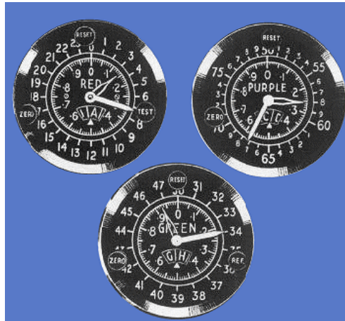
Figura I-4a. Un decómetro es una esfera indicadora similar a un reloj en la que se indica la Zona, Calle y Centésimas de Calle en la que uno se encuentra. La intersección de las líneas indicadas en sus correspondientes decómetros (hay uno por cada estación esclava) nos da nuestra posición.
