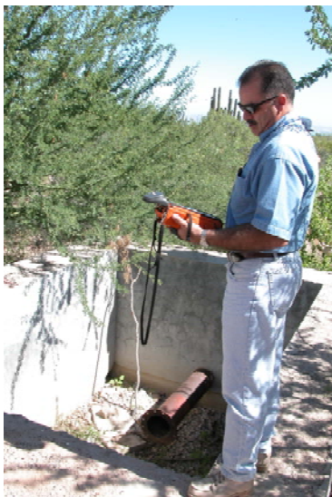
Figura III-9. Visita de inspección. Obtención de coordenadas con receptor GPS diferencial en la Dirección Local Baja California Sur
