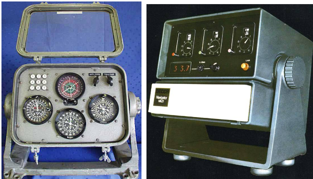
Figura I-5. Receptores Decca MK5_9Chains y MK21. Fuente: Decca Navigator España, 2005.
