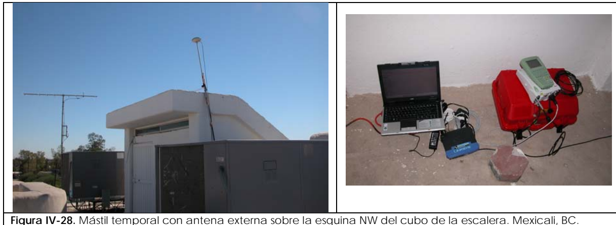
Figura IV-28. Mástil temporal con antena externa sobre la esquina NW del cubo de la escalera. Mexicali, BC.
