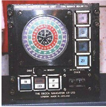
Figura I-2. Receptor para navegación aérea Decca Mk19.
