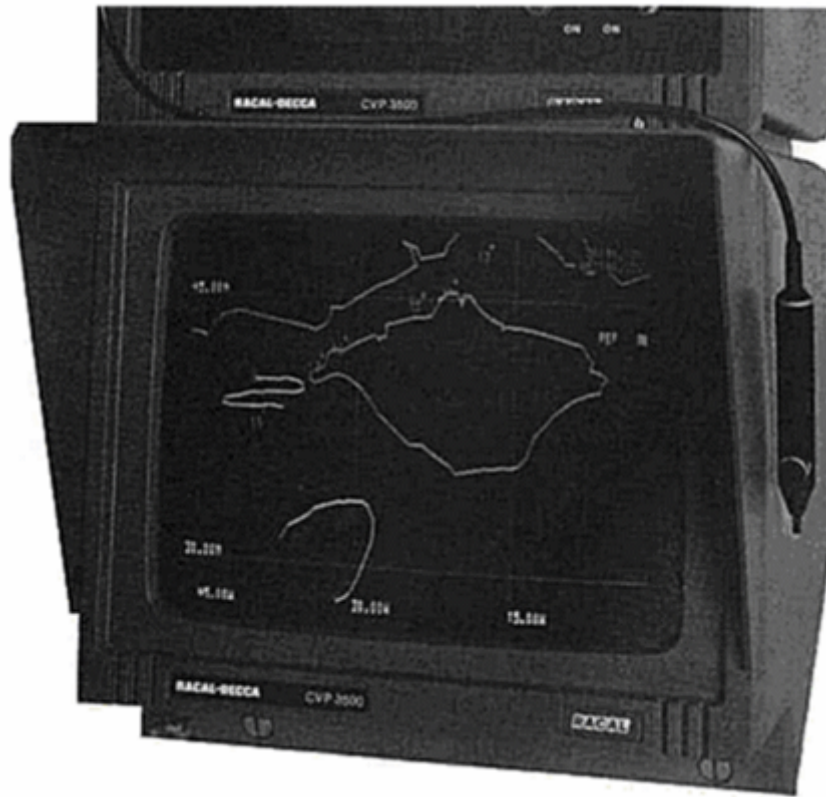
Figura I-6. VideoPlotter Decca para trazar las posiciones encontradas. Fuente: Decca Navigator España, 2005.
