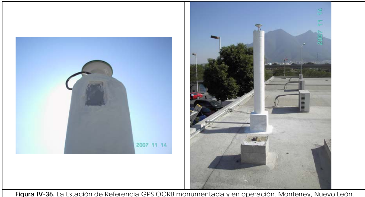
Figura IV-36. La Estación de Referencia GPS OCRB monumentada y en operación. Monterrey, Nuevo León.
