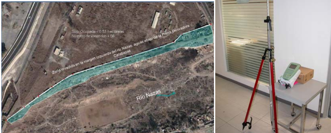
Figura III-17a. Zona invadida en la margen izquierda del Río Nazas y Equipo de doble frecuencia para aplicaciones topográficas para demarcación de zonas federales
