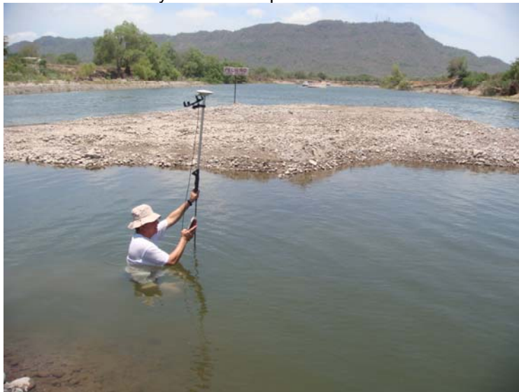
Figura III-13. Levantamiento con receptor GPS/GIS para cuantificar volumen extraído de materiales pétreos. Tepic, Nayarit.
