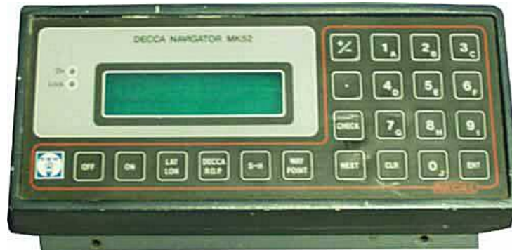
Figura I-7. Teclado alfanumérico de Receptor Decca Navigator MK52. Fuente: Decca Navigator España, 2005. Nótese la similitud en diseño con equipos GPS de los años 90's, como el Ashtech de la serie Z.
