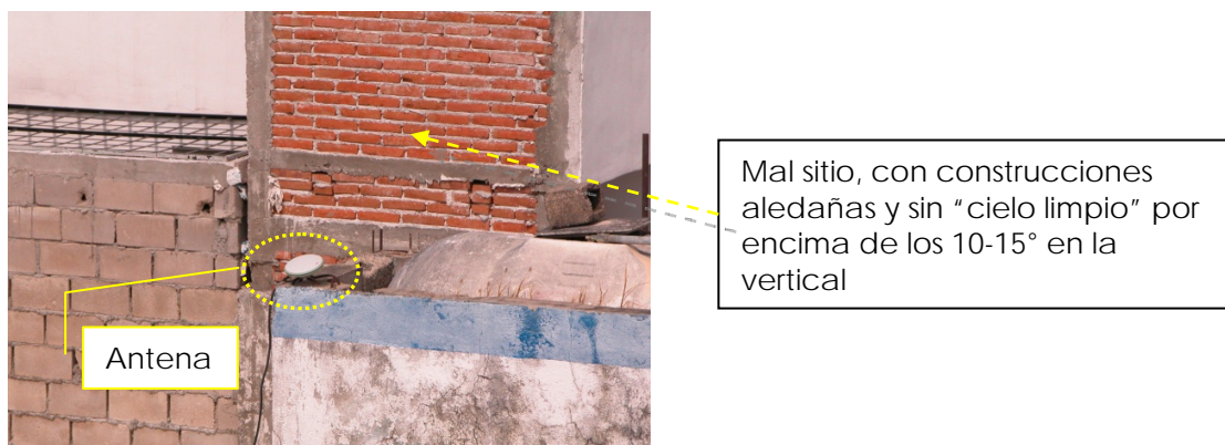
Figura IV-1. Elección del sitio. Con obstáculos y sin máscara de elevación clara de los 10 a los 15°.
