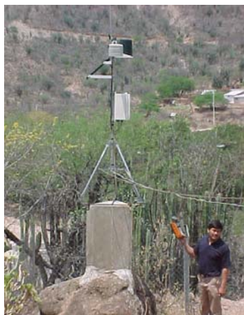
Figura III-7. Estación climatológica en Guanajuato. Personal de la Comisión obtiene las Coordenadas y atributos con equipo GPS/GIS
