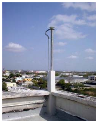
Figura IV-5. Receptor de la Estación de Referencia GPS resguardado en caseta de protección y mástil de la antena libre de obstáculos. Estación GRPY. Mérida, Yucatán.
