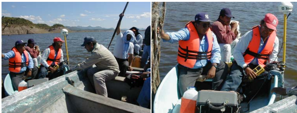
Figura III-18. Equipo de doble frecuencia para aplicaciones topográficas para levantamientos batimétricos en vasos de presas. Presa Josefa Ortiz de Domínguez, Sinaloa, México.
