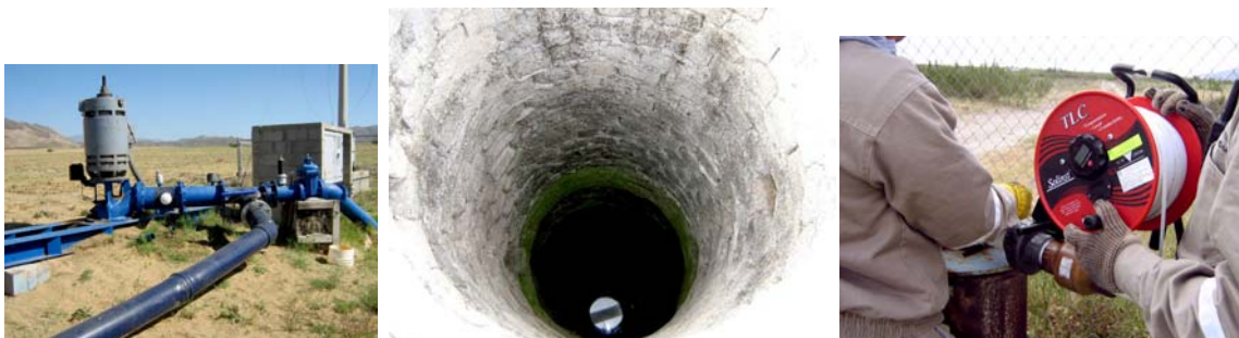
Figura III-24. Localización de un pozo de observación, noria y preparación de zonda piezométrica para medición de niveles
