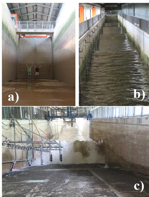
**Figura 9:** Aspectos del experimento GWK. **a)** Vista de la pala de generación desde el interior del canal de oleaje. **b)** Vista frontal de la zona de propagación del oleaje. **c)** Zona de swash con arreglo de sensores UDM, EMCM y ADVP.
