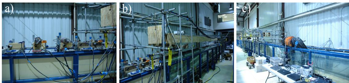
**Figura 4.10:** a) Cableado en manojito para cada estación de medición. b) Distribución de cables a lo largo del perfil de playa. c) Estación de monitoreo y adquisición de datos.
