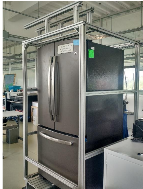
Ilustración 24 Refrigerador de prueba montado sobre un prototipo de banco de pruebas.
