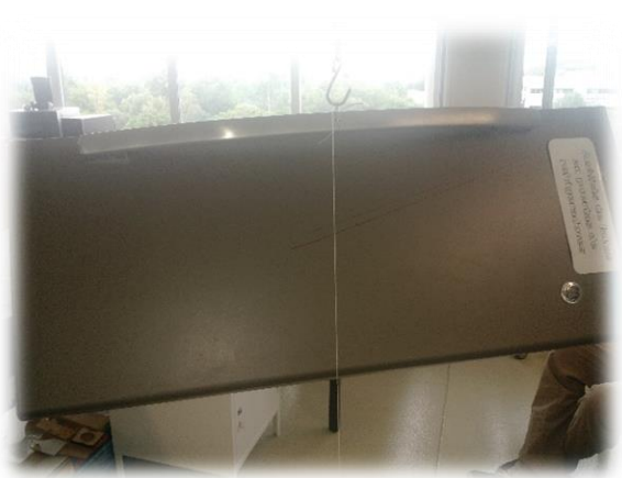
Ilustración 20 Aplicación del protocolo para la identificación del CG en la puerta del refrigerador.
