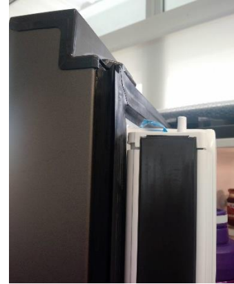
Ilustración 27 Fotografía del sello hermético de una puerta (objeto de estudio)
