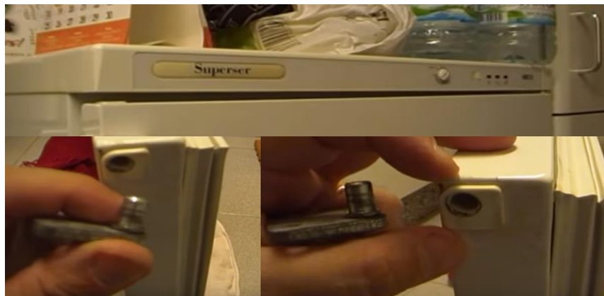
Ilustración 38 Ejemplo de falla en las bisagras de los refrigeradores lo que produce desalineación de las puertas (Ilustración obtenida del sitio reparatumismo.org)
