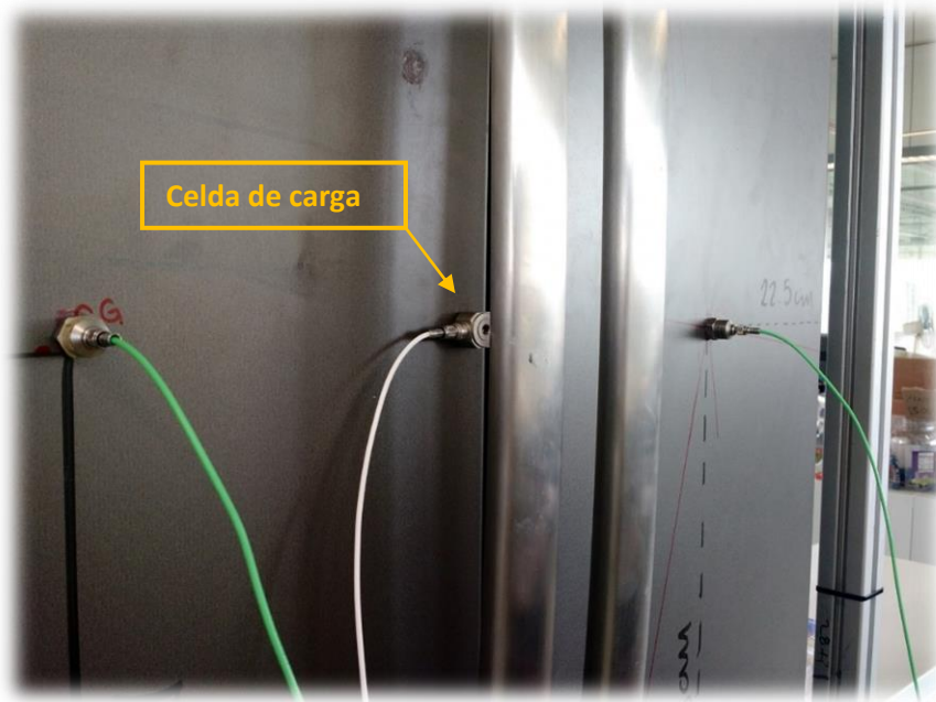
Ilustración 50 Posición de la celda de carga durante la prueba
