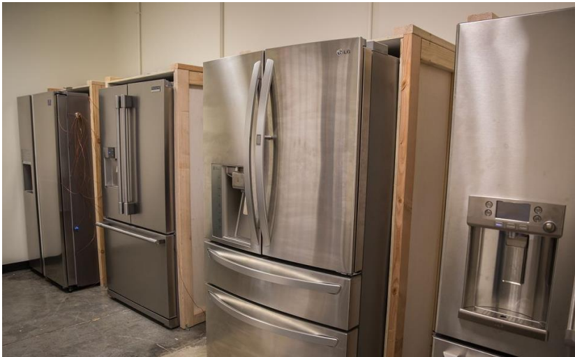
Ilustración 9 Acomodo de refrigeradores dentro de cámara climática, obtenido de norma AHAM 7001.2-2014
