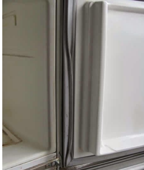
Ilustración 39 Ejemplo de deformación del sello térmico (imagen obtenida del refrigerador de un voluntario)
