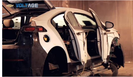
Ilustración 6 Prueba de resistencia de puertas en ambientes a bajas temperaturas para el modelo VoltAGE (Chevrolet 2010)
