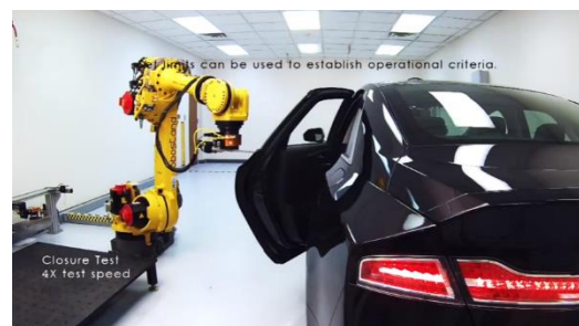
Ilustración 4 Vista lateral del sistema de apertura y cierre de puertas de automóviles (FANUC, America Corporation)
