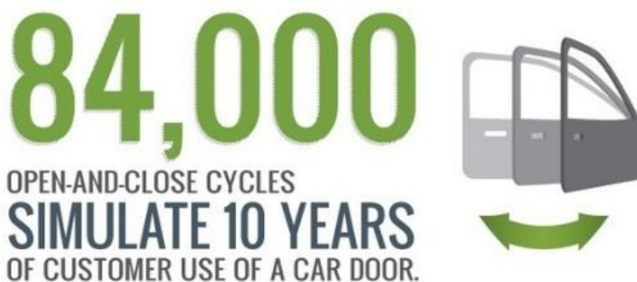
Ilustración 13 Número de ciclos que debe ejecutar un banco de pruebas de impacto en puertas.
