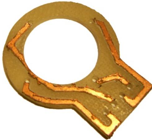
**Figura 4.16:** *Circuito externo del motor a pasos.*
