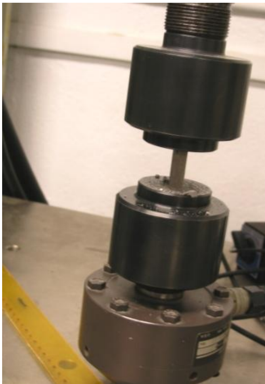
Figura 3.7 muestra una probeta de aleación de titanio sinterizada sometida a cargas de compresión
