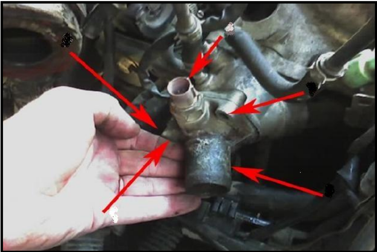
Figura 1.12 Carcasa con deterioro debida a la presencia del efecto de cavitación.
