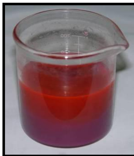
Figura 5.6 En este vaso de precipitados se encuentra material polimérico disuelto en el líquido refrigerante.
