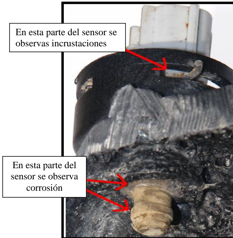
Figura 3.11 El sensor muestra evidencia de deterioro.
