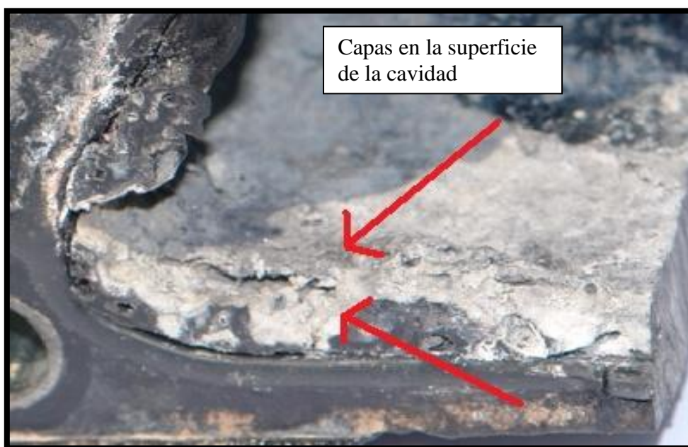
Figura 3.16 Se observan capas en el interior de la cavidad de la carcasa.
