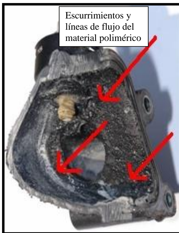
Figura 3.19 Se observan escurrimientos y residuos del polímero.
