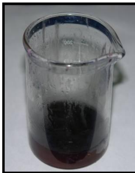
Figura 4.19 En este vaso de precipitados se muestra el desprendimiento del material en la parte inferior, donde se precipita una capa gelatinosa de fibra de vidrio.
