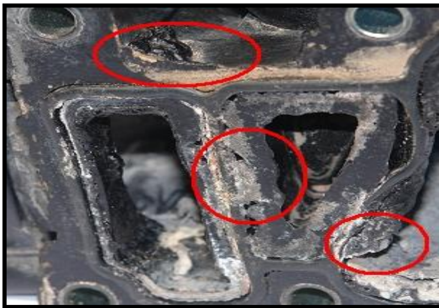
Figura 3.14 En esta carcasa son evidentes los daños por la dilatación del material.
