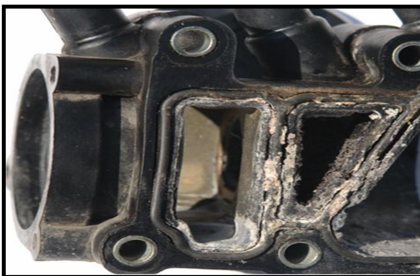
Figura 3.15 Deformación severa producto de la presencia de altas temperaturas, con lo cual se tiene la pérdida de la geometría original.
