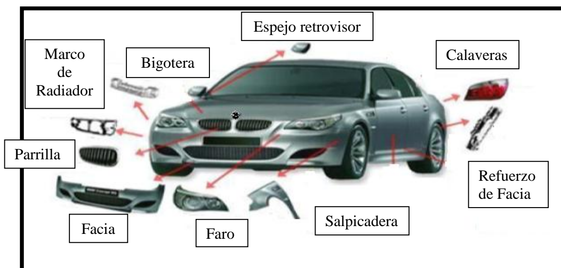
Figura 2.1 Vehículo en su mayor parte sus componentes son elaborados con materiales poliméricos [6].
