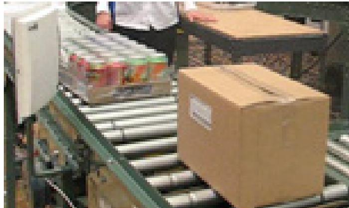
*Figura I.5.5 Identificación de palletes con tecnología RFID*
