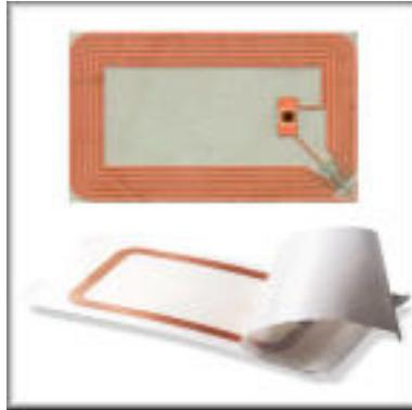
Figura I.5.1 Tarjeta RFID
