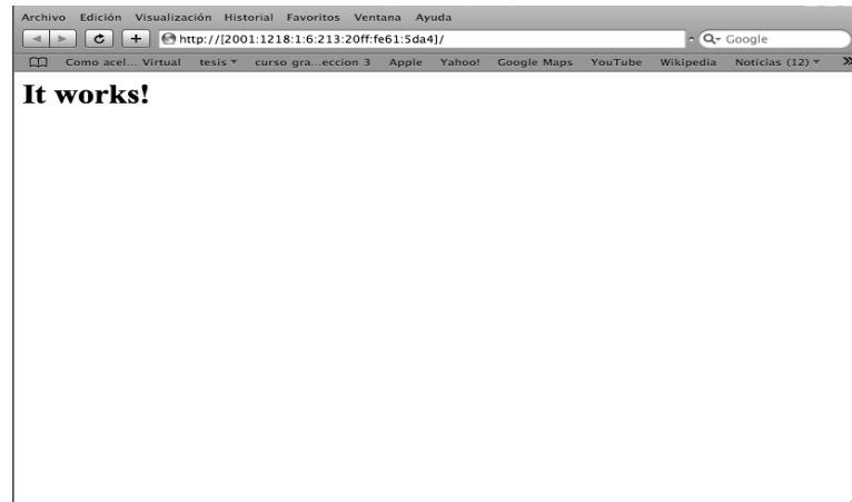
Figura 8.10 Prueba de conexión al servidor web en FreeBSD a través del navegador Safari.
