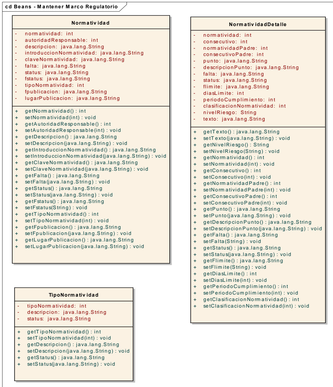
Fig. 3 - 12 Diagrama de clases: Maneja Marco Regulatorio (paquete Bean)
