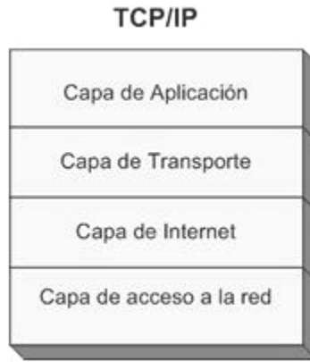
Figura 2.11 Capas del protocolo TCP/IP 27
