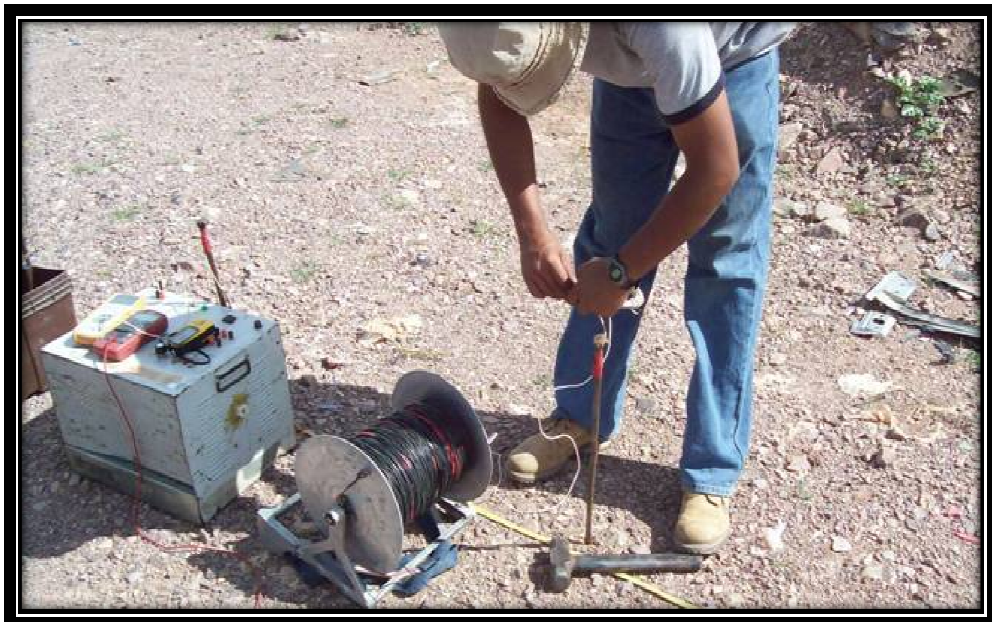
Instalación del Equipo de Exploración Geoeléctrica para Realizar el SEV-3.
