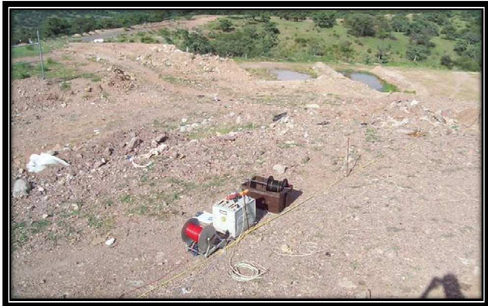
Equipo de Exploración Geoeléctrica en la Zona de Estudio.
