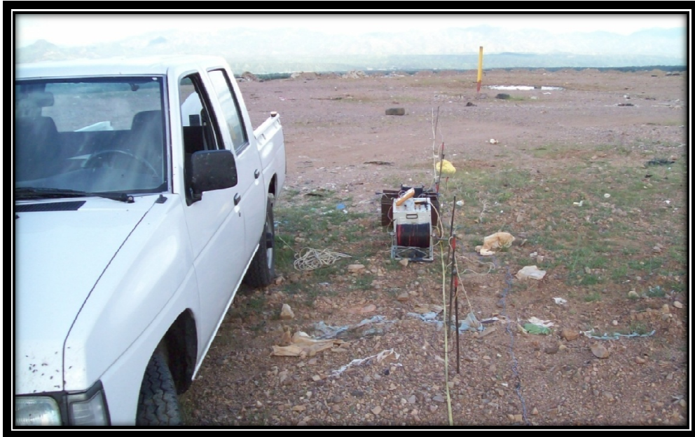
Instalación del Equipo de Exploración Geoeléctrica para Realizar el SEV-8.
