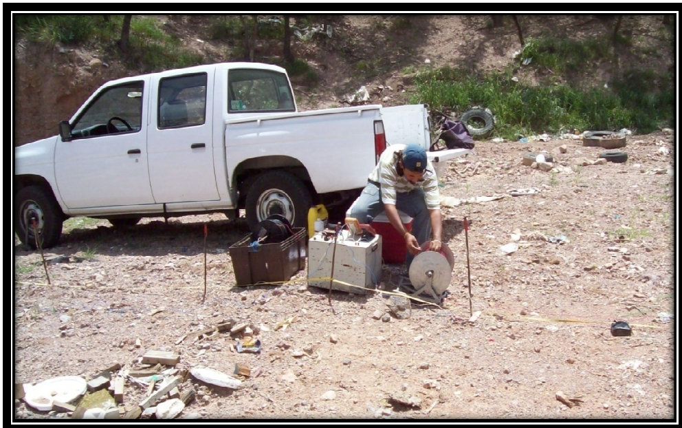
Instalación del Equipo de Exploración Geoeléctrica para Realizar el SEV-7.
