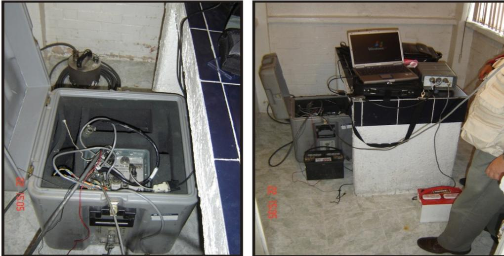
**Figura 4.3:** estación LUCI, se muestra el equipo instalado, se puede observar que el sensor se encuentra alimentado por baterías de 12 V, el enlace al sensor es por medio de una computadora portátil.
