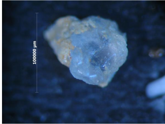
Fotografía 22. Esferulita que presenta una forma a manera de racimo de uvas, esta esferulita está compuesta de otras más pequeñas, las cuales se confirman de manera común con el microscopio petrográfico.
