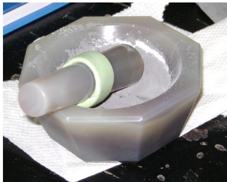
Figura 12. Mortero de ágata de diámetro de 6 cm, empleado para la preparación de muestras de FRX.
