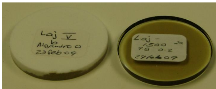
Figura 16. A la izquierda, la pastilla elaborada por el método de prensado para la obtención de elementos traza. A la derecha, la pastilla elaborada por el método de fundido, para la obtención de elementos mayores.
