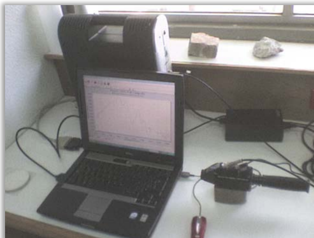
Fotografía 5. Equipo para análisis SWIR, Instituto de Geofísica, UNAM.
