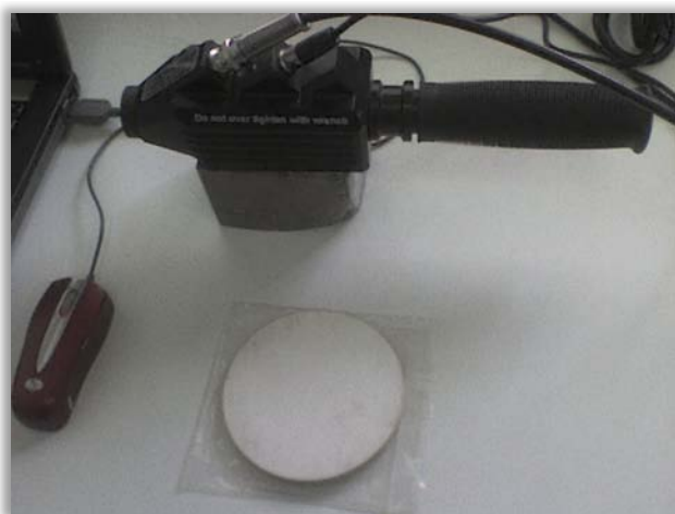
Fotografía 6. Pastilla de barita y lámpara infrarroja para toma de lecturas SWIR.
