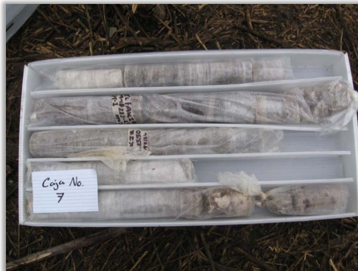
Fotografía 4. Recolección y control de muestras en caja portanúcleos.
