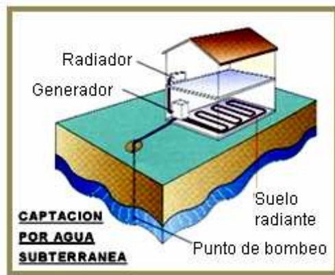
Figura IV.17 Captador vertical abierto (Tomada de Leibar, 2003).
