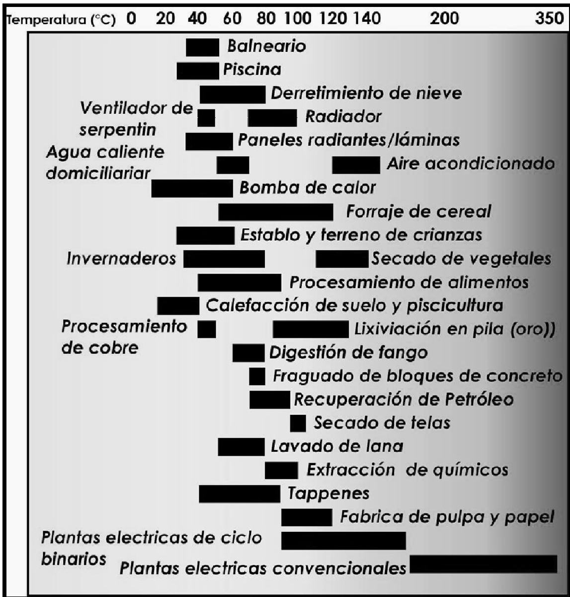
Figura IV.4 Diagrama que muestra la utilización de los fluidos geotérmicos, modificando el diagrama de Lindal, 1973 (Modificada de Dickson y Fanelli, 2004).
