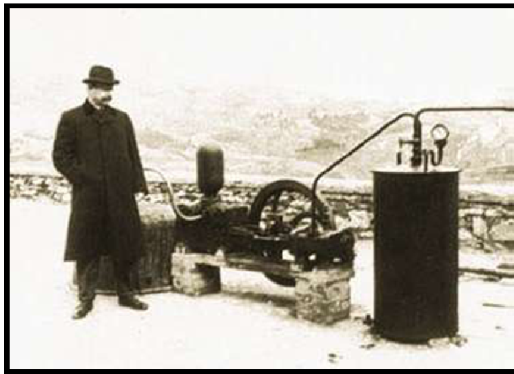
Figura IV.2 Imagen de la máquina usada en Larderello en 1904 en la primera experiencia de generación de energía eléctrica mediante vapor geotérmico, con su inventor, el Príncipe Piero Ginori Conti (Tomada de Dickson y Fanelli, 2004).
