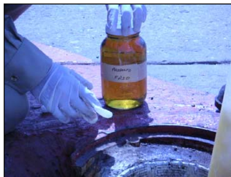
Fotografía III.12.1 Muestreo de LNAPL en pozos para su posterior análisis.
