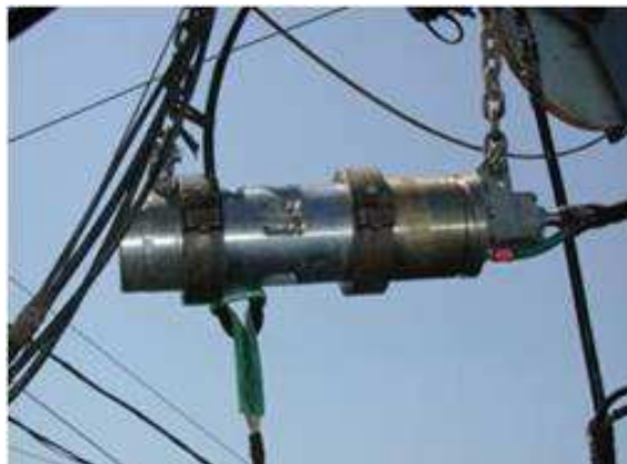
Figura 3.8. Esquema del cañon de aire. La fuente más común empleada en la sísmica de reflexión en la exploración marina (Elements of 3D Seismology. Por Chris Liner.ppt).
