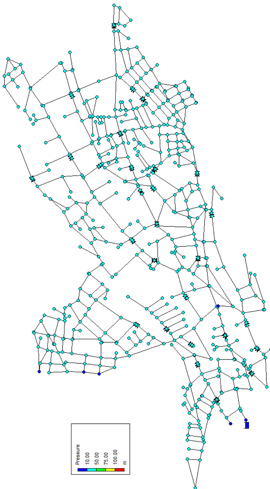
Figura 6.15: Sector Reynaco, Localización de VRP.
