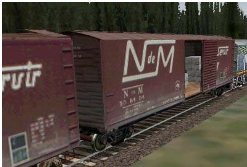
Figura 2.14. Vagones con Bogies de cuatro ejes normalmente utilizado para los caminos ferroviarios de México.
