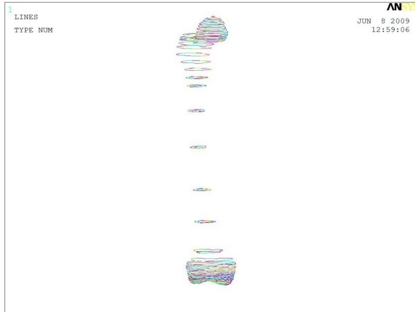
Figura 4. Cortes importados en Ansys para la construcción del volumen del fémur a partir de líneas, y donde se muestra únicamente la sección de fémur que se usará para las simulaciones.
