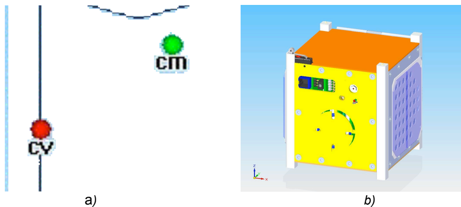
Figura 4.11. a) Centro de masa y centro geométrico. b) Paneles y antenas plegados.
