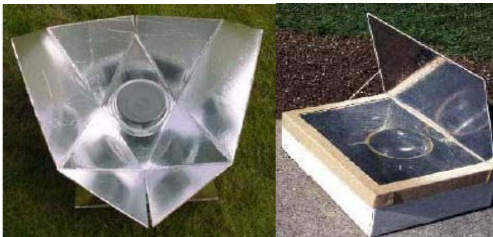
Figura 1.4. Izquierda se muestra un horno de paneles, a la derecha un horno de acumulación. Obtenidas de [http://www.cie.unam.mx/~ojs/pub/Presentaciones/Cocinando\\_SOL.pdf](http://www.cie.unam.mx/~ojs/pub/Presentaciones/Cocinando_SOL.pdf)
