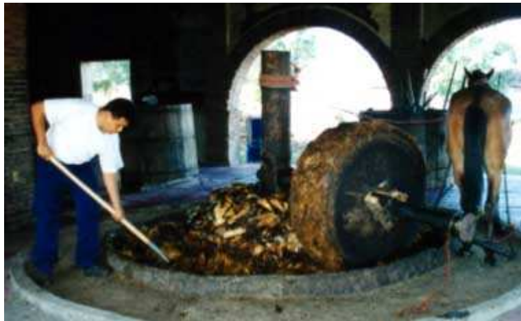
Figura 4. Trituración de los trozos de “piña” en el molino
