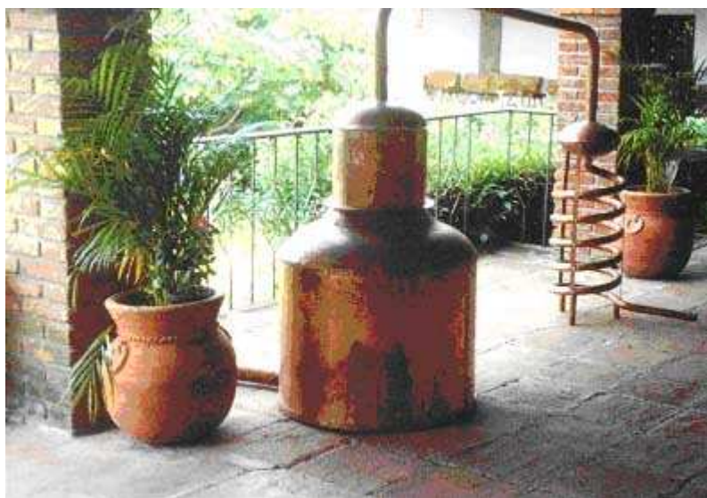
Figura 7. Campana y serpentín del alambique
