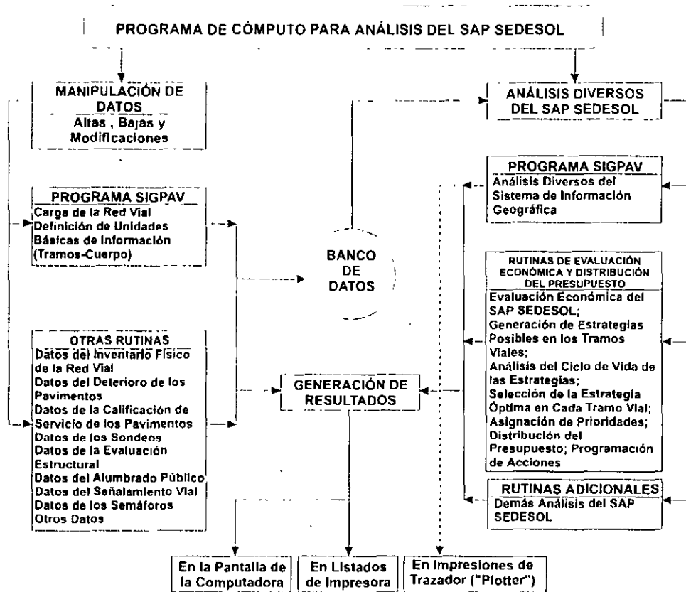
Figura 8. Esquema simplificado de los procesos principales del programa de cómputo para análisis del SAP SEDESOL.
