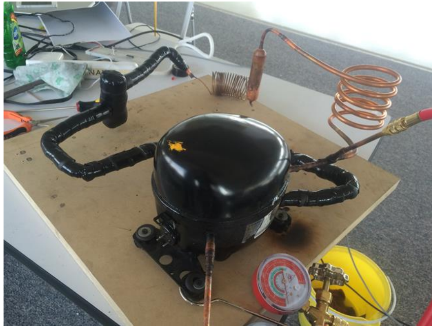
Figura 3.4. Sistema con el tubo del evaporador aislado
