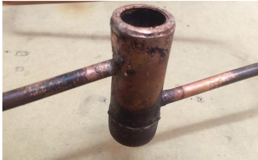
Figura 3.2. Molde evaporador de cobre soldado
