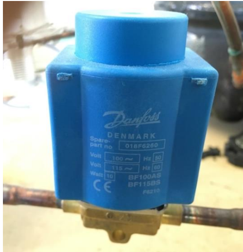
Figura 3.10. Válvula solenoide utilizada para el desmolde
