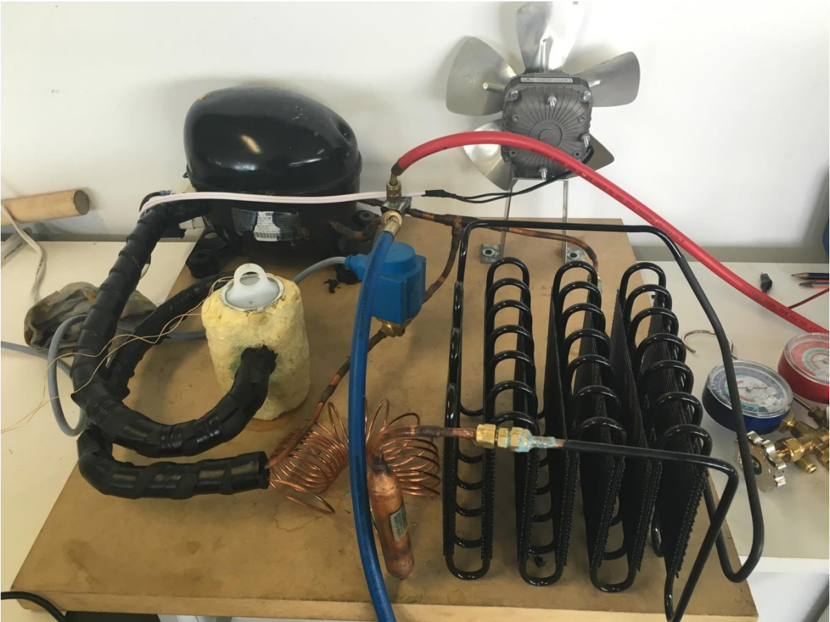
Figura 3.13. Sistema de fabricación de hielo con el segundo prototipo de molde evaporador
