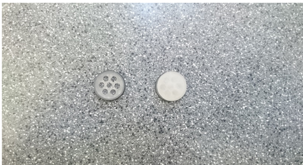
Figura 7.7: Filtros de 25 \mu\text{m} , discos sostenedores
