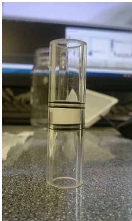
Figura 7.12: Calcita empacada dentro de la celda
