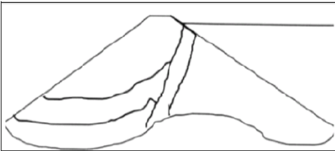
Figura 44. Tubificación (erosión interna)
