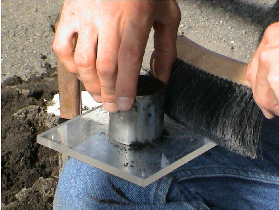
Figura 3.3 Determinación de la densidad aparente.
