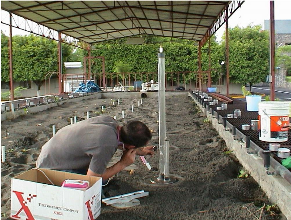
Figura 3.5 Vista de una de las veinte pruebas de infiltración.
