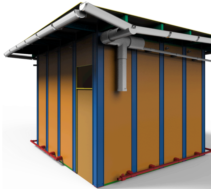
Fig. 28. Colocación de puertas y ventanas convencionales sobre los soportes verticales (Amarillo).
