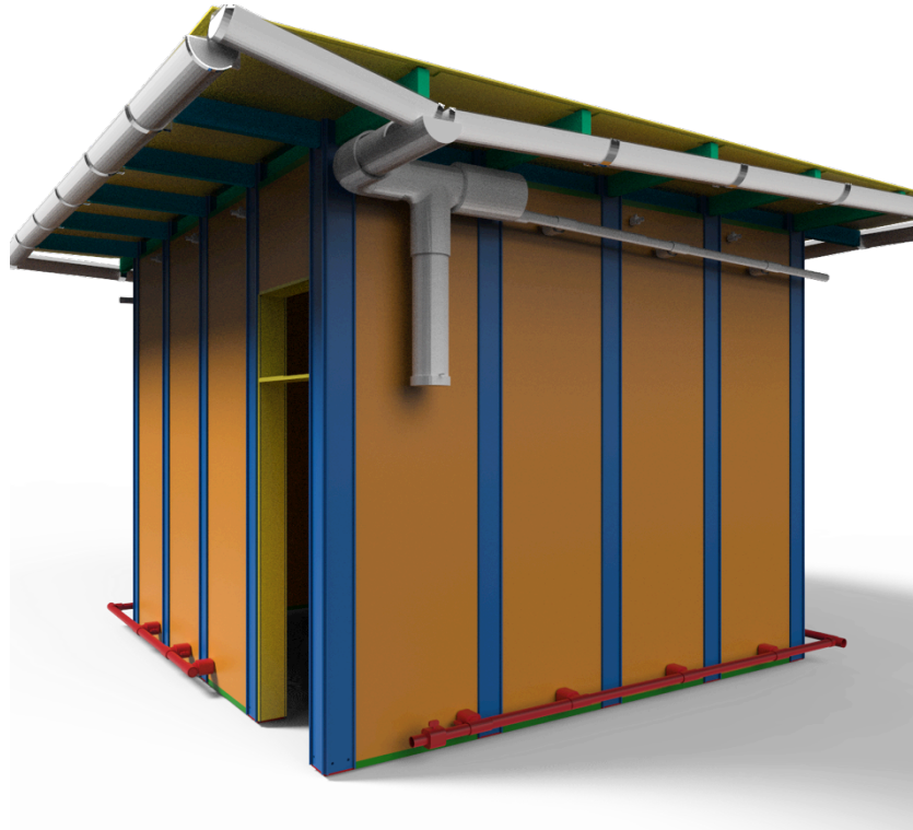
Fig. 27. Instalación de Tubo inferior, línea de extracción del agua almacenada.
