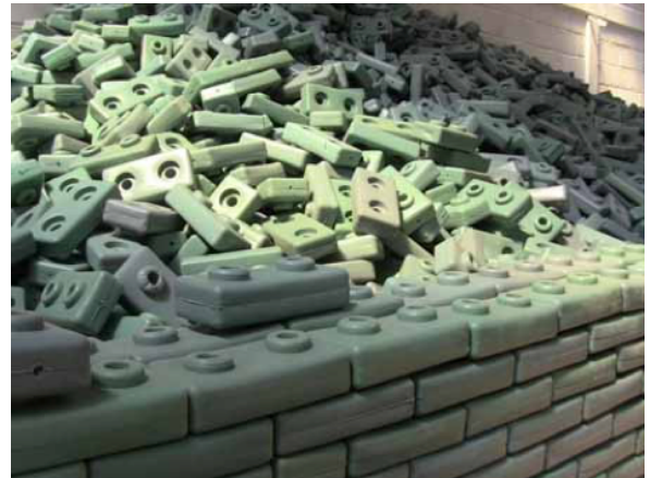
Fig. 4. Ladrillo mexicano fabricado con PET. [L:12]
