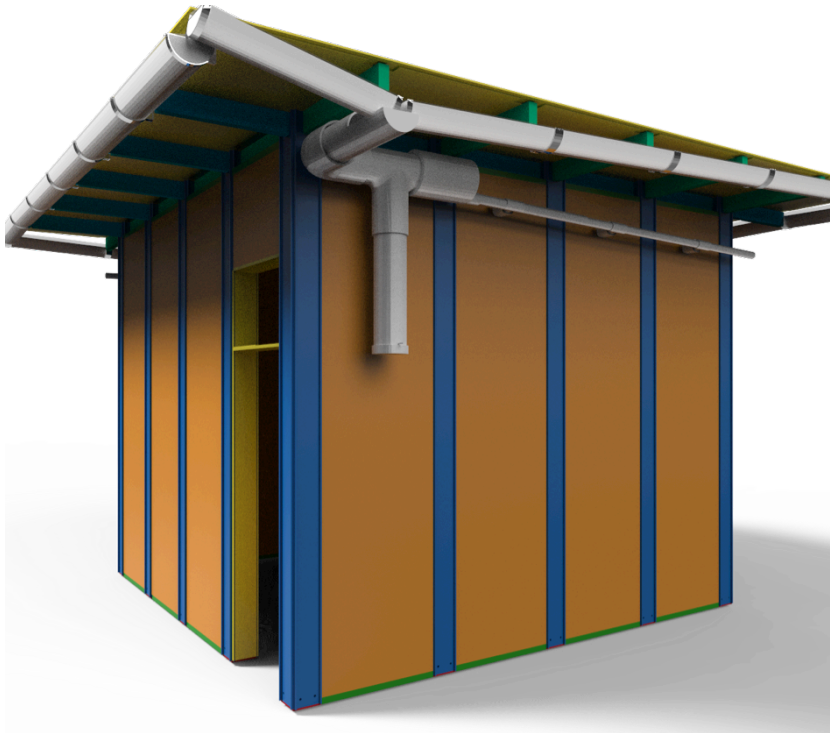
Fig. 26. Instalación de Tubo de distribución.
