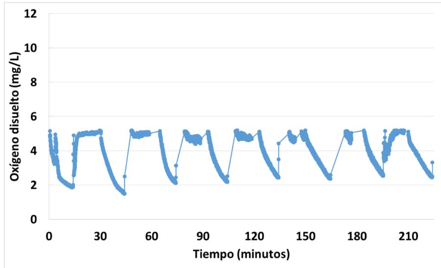
**Figura A.1. Respirometría con consumo de oxígeno total para carga orgánica de 5.3 g/m<sup>2</sup>·d**
