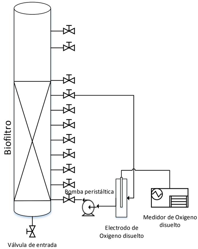
**Figura 6.4. Diagrama de experimento para realización de pruebas de respirometría**
