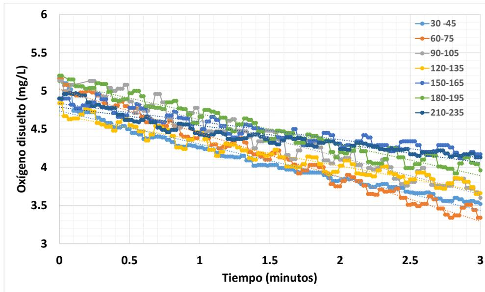
**Figura B.1. Pendientes de consumo de oxígeno total para la carga 5.3 g/m<sup>2</sup>·d.**
