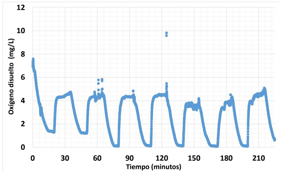
**Figura 7.27 Respirometría con consumo de oxígeno total para carga orgánica de  $8.1 \text{ g/m}^2\cdot\text{d}$ .**
