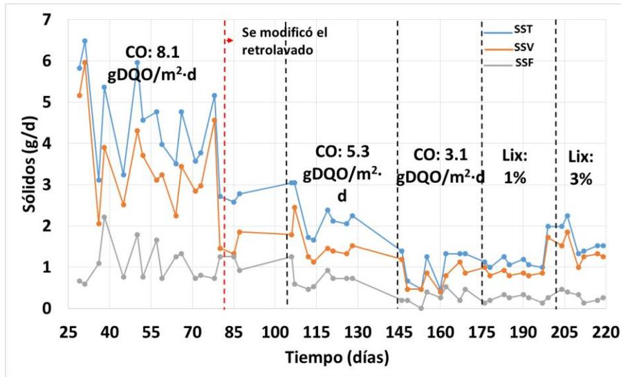
**Figura 7.21. Comportamiento de sólidos en el efluente.**
