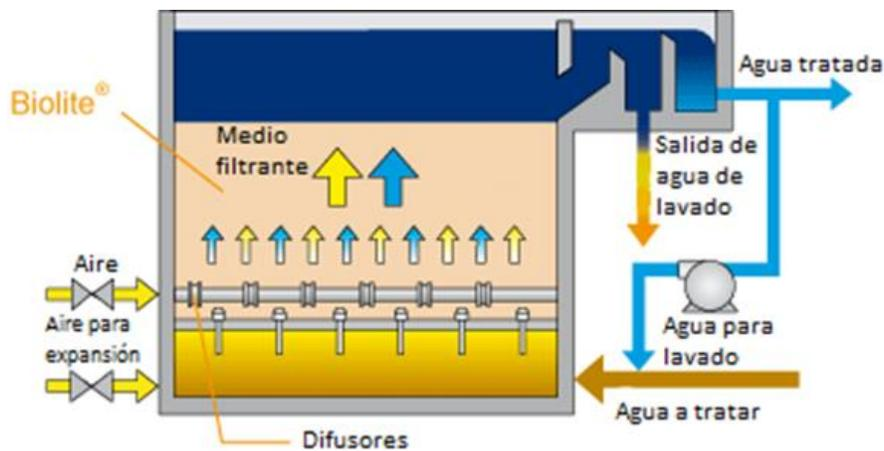
**Figura 3.1. Diagrama básico del funcionamiento de filtro biológico aireado**
