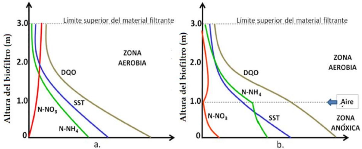
**Figura 3.2. . Perfiles de concentración de nutrientes en un filtro biológico aireado con soporte poroso. a) Filtro en una etapa b) Filtro en dos etapas y recirculación de agua tratada. Fuente: modificado de González-Martínez et al. 2006.**
